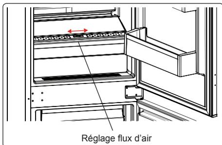
Si le compartiment à légumes est plein, le réglage flux d'air situé à l'avant du compartiment doit être ouvert. Ceci permet la pénétration de l'air dans le compartiment à légumes et le contrôle du taux d'humidité afin d'augmenter la durée de vie des aliments.
